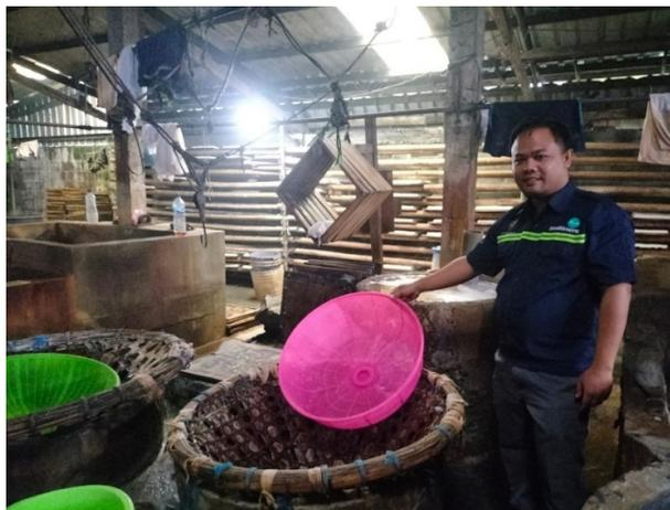
Gambar 1. Peralatan penyaring sari pati kedelai manual
