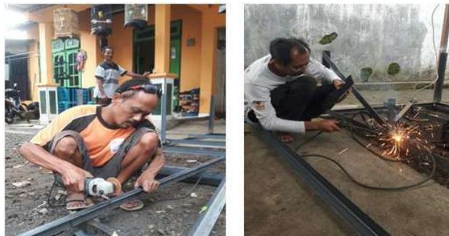
Gambar 4. Proses Pengelasan/Pembuatan *Frame Acrilic*
