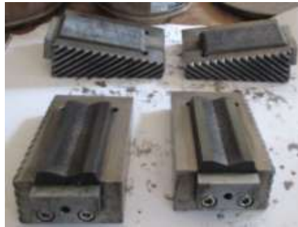
Gambar 5.1 Alat cekam mesin UTM yang sudah dimodifikasi
