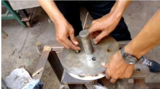
**Gambar** Pemasangan Pin Pengunci *Roller*
