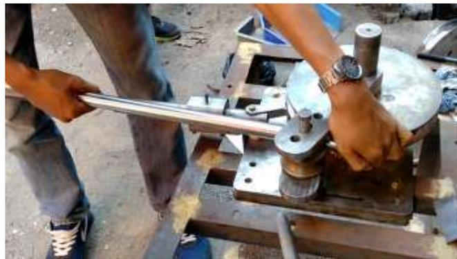
**Gambar** Pemasangan Pipa Pada *Roller*
