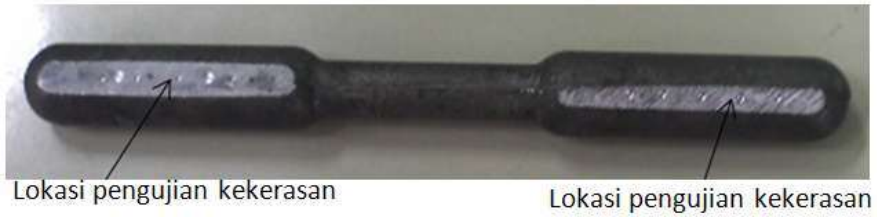
Gambar 6. Spesimen benda uji
