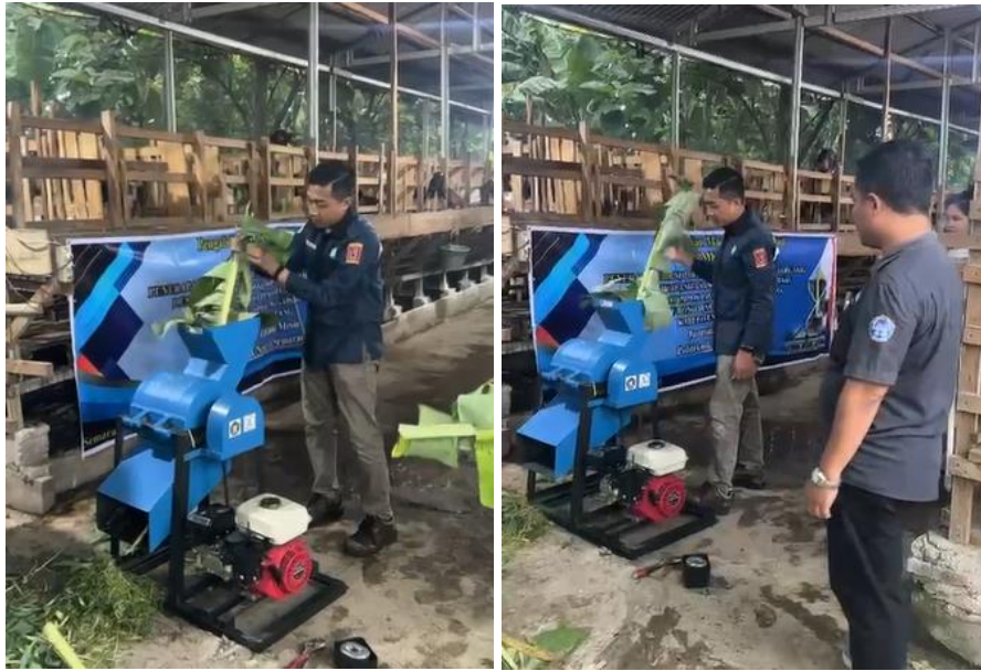
Gambar 3. Uji coba mesin pencacah sampah organik
