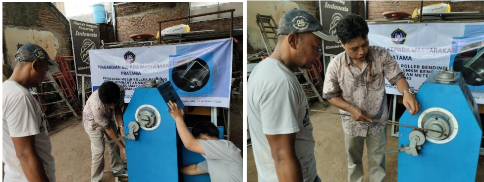
Gambar 5. Pelatihan Pengoperasian Mesin Scroll Bending ke Mitra
