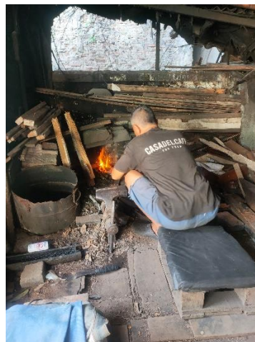
Gambar 6.4 Proses Pengerjaan Palu-Palu Besi Tukang
