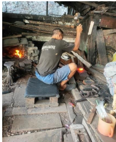
Gambar 6.2 Proses Pengerjaan Palu-Palu Besi Tukang
