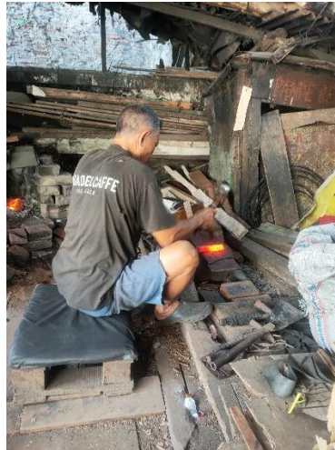
Gambar 6.3 Proses Pengerjaan Palu-Palu Besi Tukang
