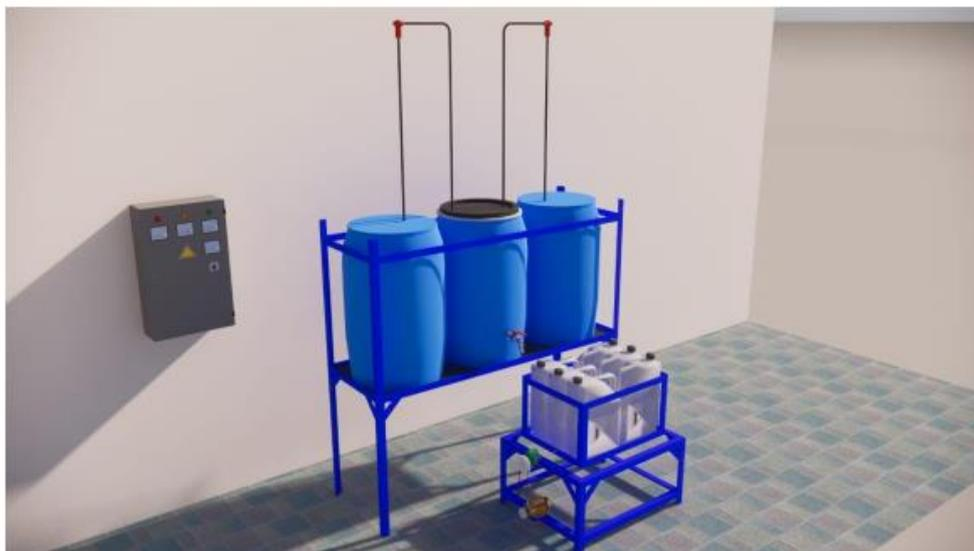
Gambar 3. Desain konstruksi mekanik mesin pembuat pupuk organik otomatis
