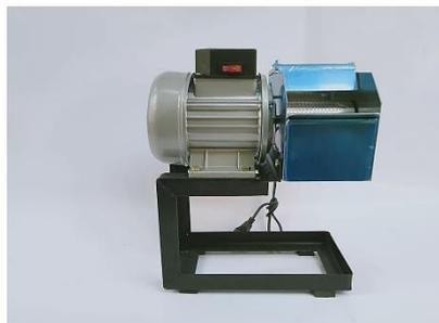
Gambar 4. Desain 3D Mesin Pencacah “CaPres” (CAcah PeRES) dari Tim Pengabdian
