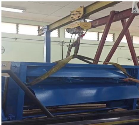
Gambar 3. Simulasi pengangkatan alat potong plat dengan *crane*
