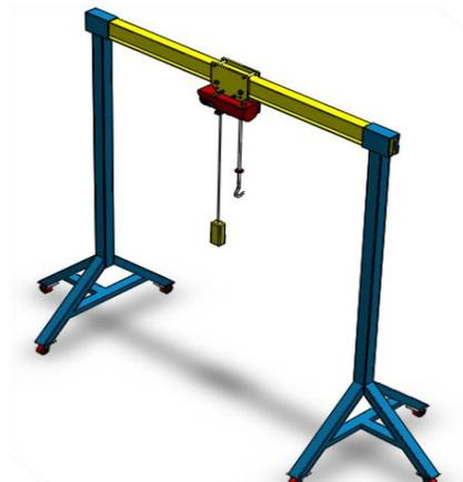
Gambar 2. Alat Bantu Angkat (*crane*) Kapasitas 800 kg
