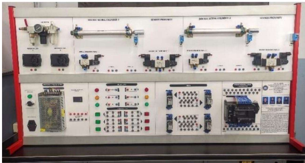
Gambar 3 Hasil akhir konstruksi training kit
