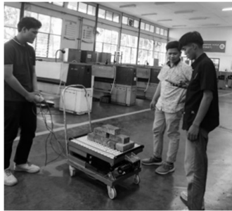
Gambar 7. Uji kinerja pengangkatan beban
