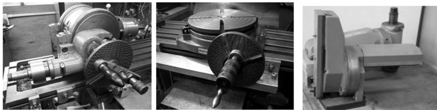
Gambar 1 Kepala pembagi pada mesin frais ( 35 kg), meja putar mesin frais (45 kg) Kepala slot mesin frais ( 25 kg)
