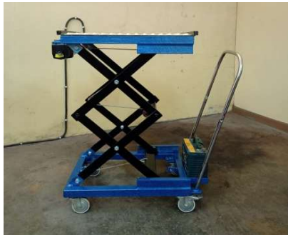
Gambar 6. Realisasi rancangan peralatan angkat dan angkut yang direncanakan akan mampu mengangkat beban hingga 100 kg
