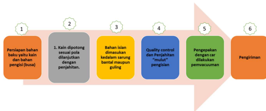
Gambar 1.3 Alur mekanisme produksi pembuatan bantal dan guling vacuum.
