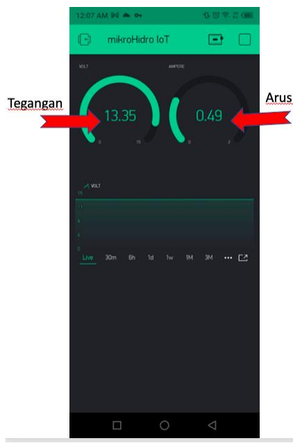
Gambar 11. (a) Monitoring Blynk App IoT, (b) Uji coba menggunakan Alat Ukur
