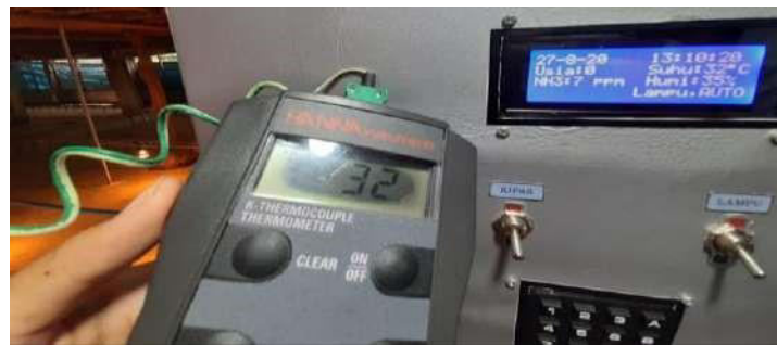
Gambar 6. Tampilan LCD untuk Pengukuran DHT11 Ketika Suhu pada Nilai Batas Bawah dan Lampu Menyala
