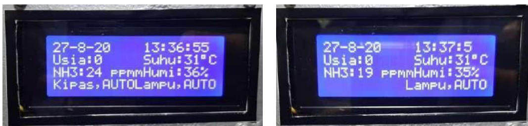
Gambar 4. (a). Tampilan LCD Nilai Amonia Ketika Kipas Memory Menyala, (b) Tampilan LCD Nilai Amonia Ketika Kipas Mati pada Amonia di Bawah Batas Bawah Amonia
