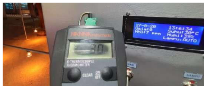
Gambar 7. Tampilan LCD untuk Pengukuran DHT11 Ketika Lampu Menyala Memory
