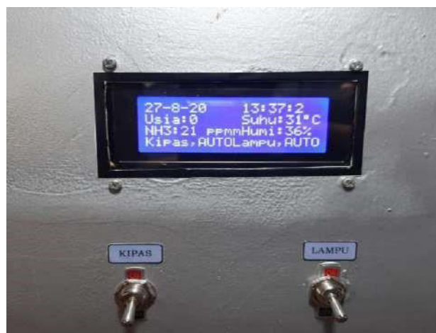
Gambar 11. Tampilan LCD untuk Sakelar Manual Kipas Dan Lampu Pemanas Ketika Kondisi OFF
