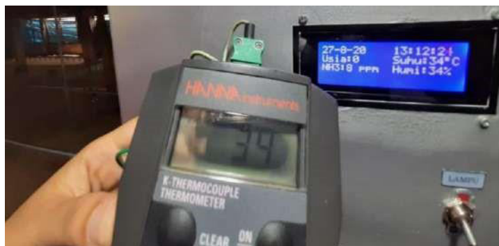
Gambar 8. Tampilan LCD untuk Pengukuran DHT11 Ketika Suhu di Atas Nilai Batas Atas dan Lampu Padam
