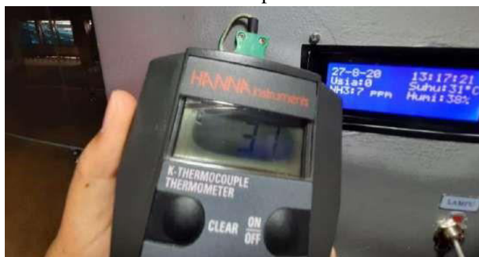
Gambar 8. Tampilan LCD untuk Pengukuran DHT11 Ketika Suhu di Atas Nilai Batas Atas dan Lampu Padam
