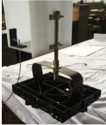
Gambar 8 Pemasangan Canting Cap
