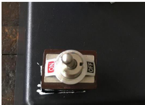
Gambar 7 Sakelar Toggle di Mode Otomatis
