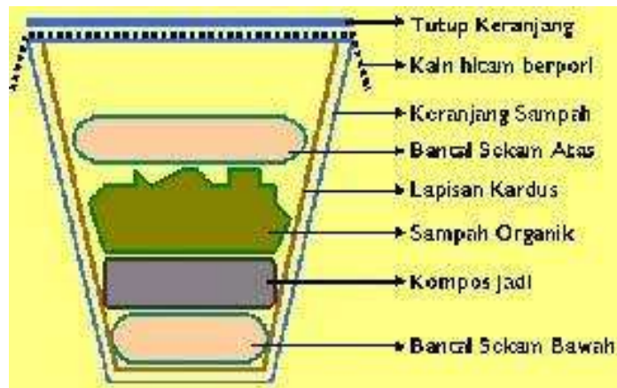
Gambar 3.4 : Susunan lapisan dalam proses pembuatan kompos
