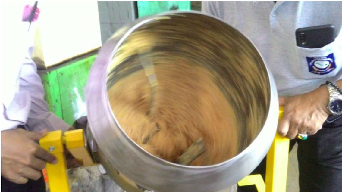
Gambar 10. Uji Coba Mesin Penyangrai Rebung yang Berputar
