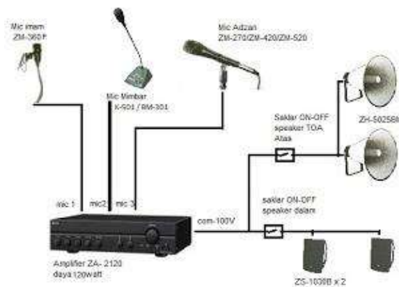
Gambar 1. Skema instalasi dalam system tata suara
