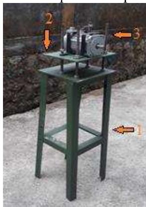
Gambar 4. 3 Dudukan Generator: (1) kerangka; (2) meja; (3) pengatur tinggi meja.
