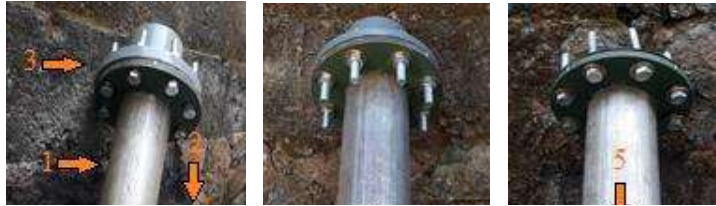
Gambar 4. 4 Nosel: (a) tampak samping: 1. badan nosel, 2. Pengatur jarum, 3. Sambungan flange; (b) tampak depan (tutup penuh): 4. Jarum; (c) tampak depan (bukaan penuh): 5. Kepala nosel.
