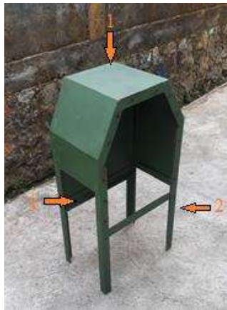
Gambar 4. 2 Rumah Turbin: (1) penutup; (2) kerangka; (3) tempat masuk nosel.
