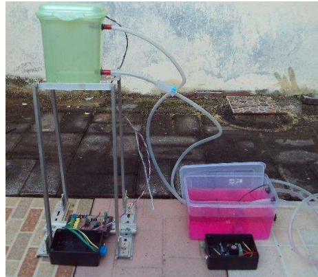
Gambar 5.1. Sistem kendali pompa air otomatis nir kabel.
