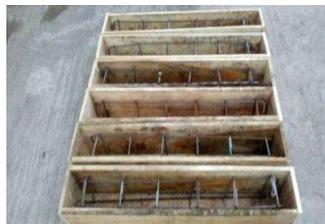
**Gambar 6. Pemasangan Tulangan Komposit Benda Uji Balok**
