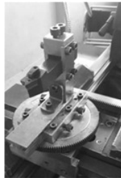
Gambar Penyempurnaan rancangan perangkat alat bantu proses pembubutan bentuk bola untuk mesin bubut EMCO MAXIMAT dan CELTIC 16
