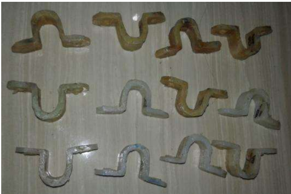
Gambar 7. Produk bahan PET setelah mengalami uji tekan sampai retak atau pecah
