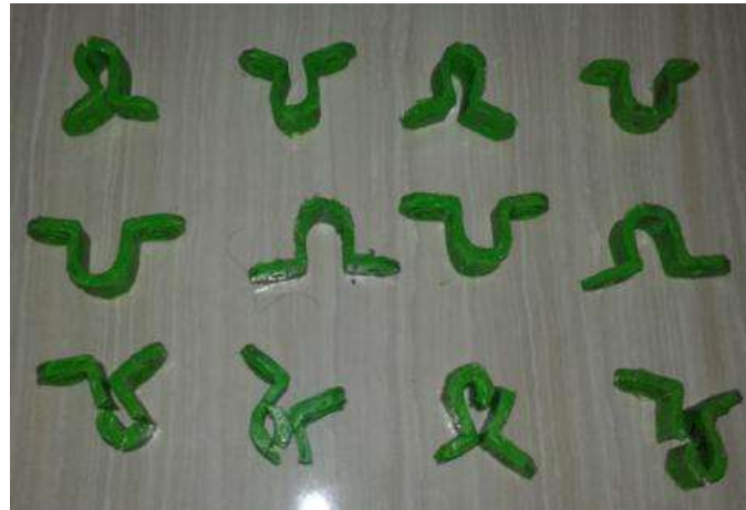
Gambar 8. Produk bahan PP setelah mengalami uji tekan sampai retak atau pecah
