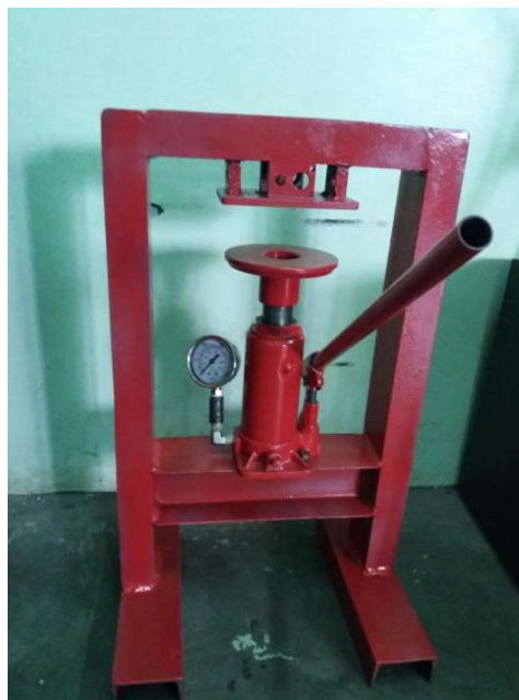
Gambar 3 prototype alat bantu pemadat pasir pada cetakan pasir
