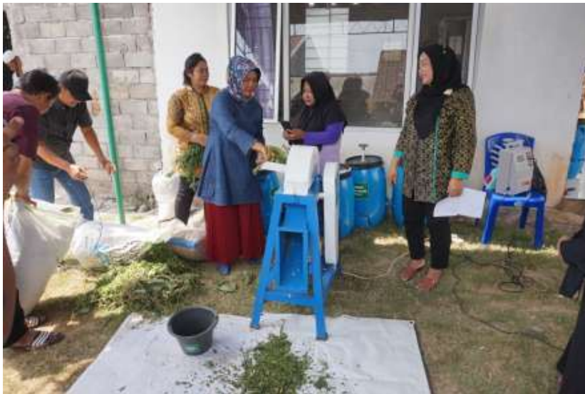
Gambar 2 : Merajang sampah dengan Mesin Perajang
