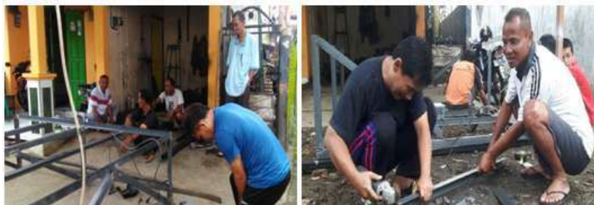
Gambar 2. Proses Pengelasan/Pembuatan Frame Acrylic
