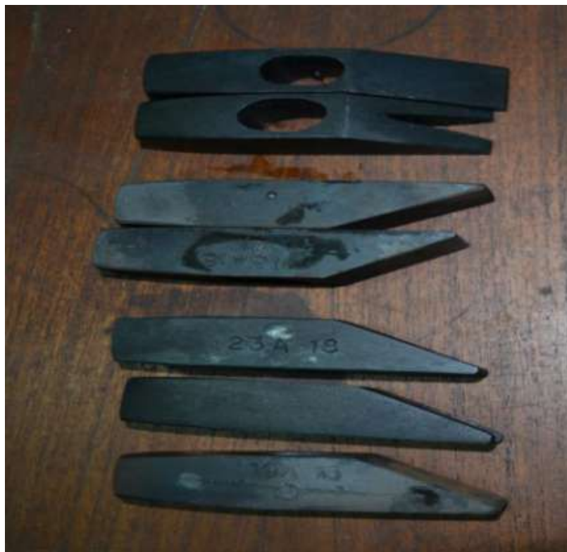
Gambar 2, kepala palu setelah dilakukan perlakuan panas
