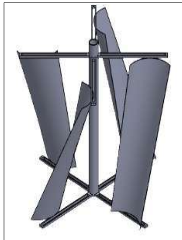
Gambar 8. Runner turbin dengan jumlah sudu 4
