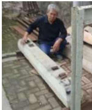
Foto 2. Bantalan beton di Laboratorium Jurusan Teknik Sipil
