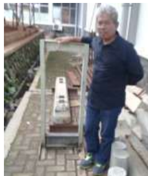
Foto 3. Frame untuk uji lentur bantalan beton
