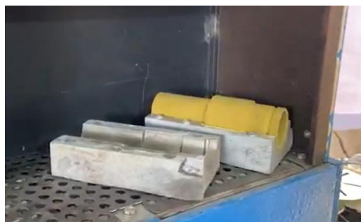
Gambar 2. Pembuatan inti cetakan menggunakan dapur pemanas listrik
