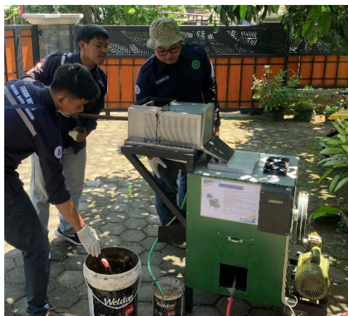
Gambar 3. Demo pengoperasian mesin pengolah slurry berbasis energi biomassa
