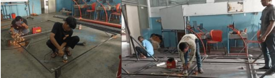
Gambar 6. Aktifitas mahasiswa pelaksanaan KKN tema PMM dalam pembuatan rangka PLTS untuk pompa air.
