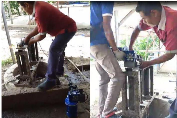
**Gambar 3.** Proses pemasangan motor penggerak dan uji kerja alat pengaduk
